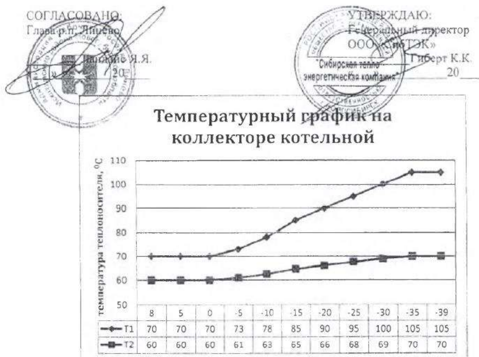
Рисунок 1. Температурный график Линевской газовой котельной
