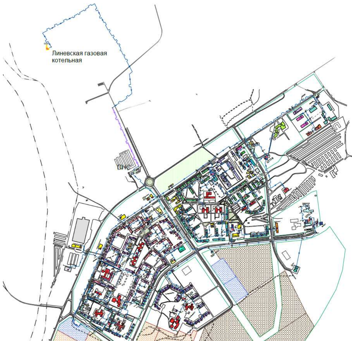
Рисунок 3. Схема тепловых сетей от Линевской газовой котельной
